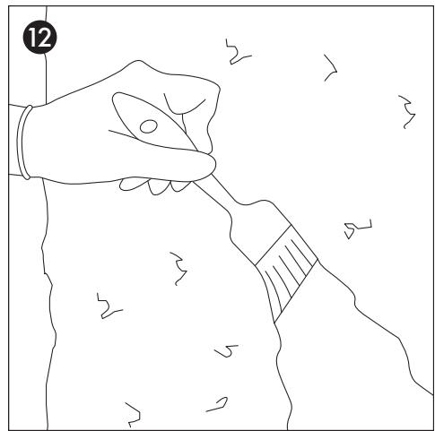
Reinigen Sie die Fugen vorsichtig mit 120er Schleifpapier. Achten Sie darauf, die gespachtelte Struktur nicht abzuschleifen.
