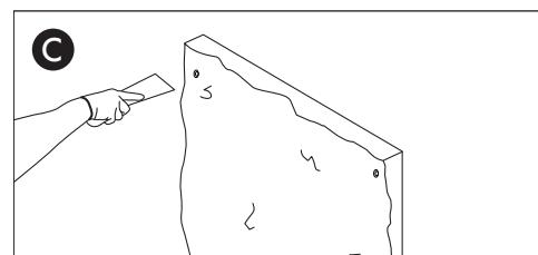
Bohren Sie 4 Löcher in die Ecken der Paneele, in einem Abstand von ca. 5 cm von der Kante. Je nach Wandkonstruktion verwenden Sie Schrauben oder Dübel und beachten Sie dabei, dass eine Senkung der Bohrlöcher das Verdecken erleichtert.
