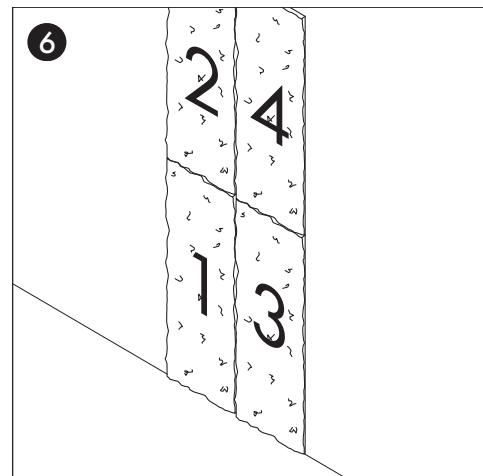
Tragen Sie den Montagekleber auf die Rückseite des Paneels mit einer Zahnkelle auf.
