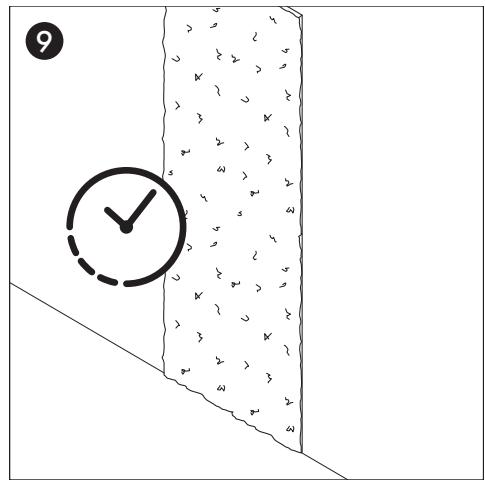
Tragen Sie die Spachtelmasse Creativa auf oder füllen Sie die Fugen zwischen den Paneelen mit Spachtelmasse aus der Kartusche mithilfe einer Kartuschenpistole.
